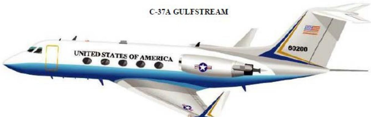
Die C-37A wird für den Personentransport genutzt. Sie besitzt zwei Turbo-Triebwerke, welche sich am Rumpf befinden und ist mit serienmäßig montierten kleinen Flügeln ausgestattet. Die C-37A ist als Großflugzeug für Mindeststandards zur Verhinderung von Wirbelschleppen klassifiziert.
