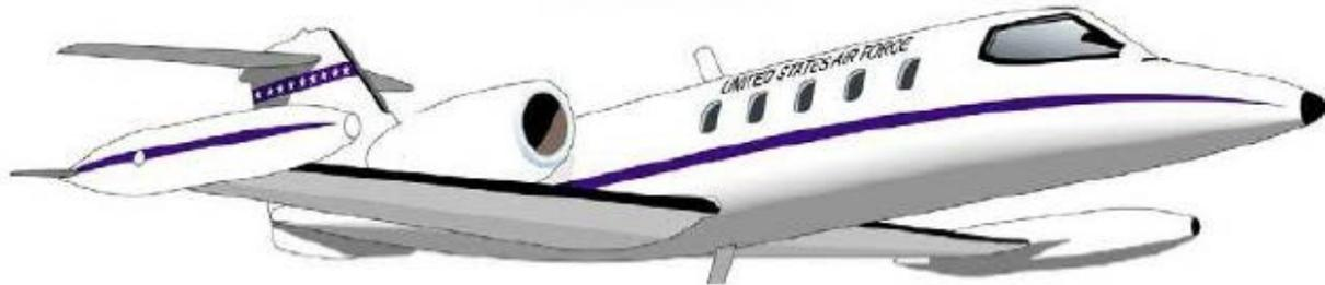
Die C-21 ist ein Flugzeug mit zwei Turbo-Triebwerken, welche sich auf beiden Seiten des hinteren Rumpfes befinden. Die C-21 wird vorrangig für den Passagierverkehr eingesetzt.
