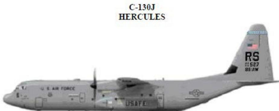
Die C-130J ist ein taktisches Lufttransport- und Luftlandeflugzeug. Das Einsatzspektrum erstreckt sich von Such- und Rettungsmissionen in der Luft und zu Wasser, bis zu Aufklärungs- und Forschungszwecken. Die C-130 ist serienmäßig mit hoch montierten Flügeln ausgestattet und wird von vier Turboprop-Motoren angetrieben. Die C-130 ist klassifiziert, als ein großer Flugzeug, welches die Mindeststandards zur Verhinderung von Wirbelschleppen erfüllt.
