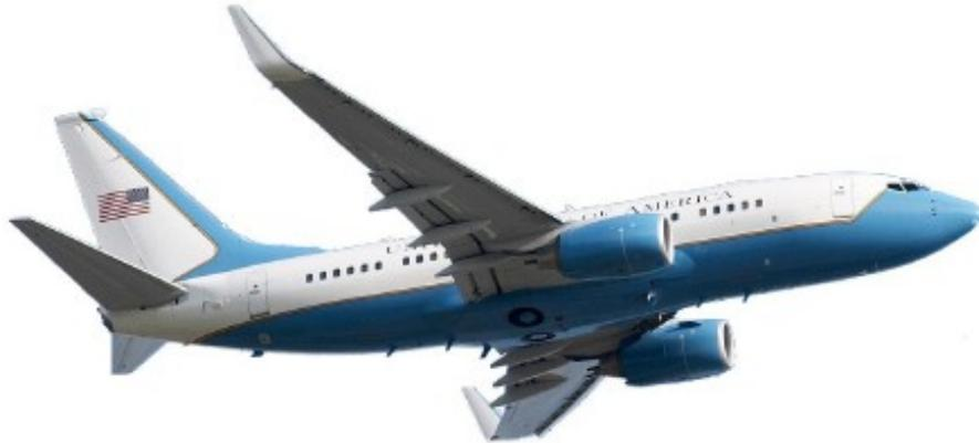
Die C-40 B basiert auf dem kommerziellen Boeing 737-700 Business Jet und wird für den Personentransport eingesetzt. Die C-40B ist ein standardmäßig konstruiertes (Tief-)Flügelflugzeug mit zwei Turbojets, die sich jeweils unter dem Flügel links und rechts befinden. Die C-40B ist nach den Mindeststandards für die Minimierung von Wirbelschleppen als großes Flugzeug klassifiziert.
